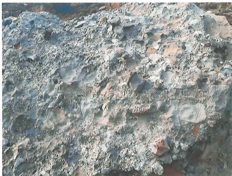
Figura 3-3 Depósitos de origen glaciares, conglomerados polimícticos en matriz areno arcillosa sumamente compactada se aprecia en forma aislada en área del proyecto
