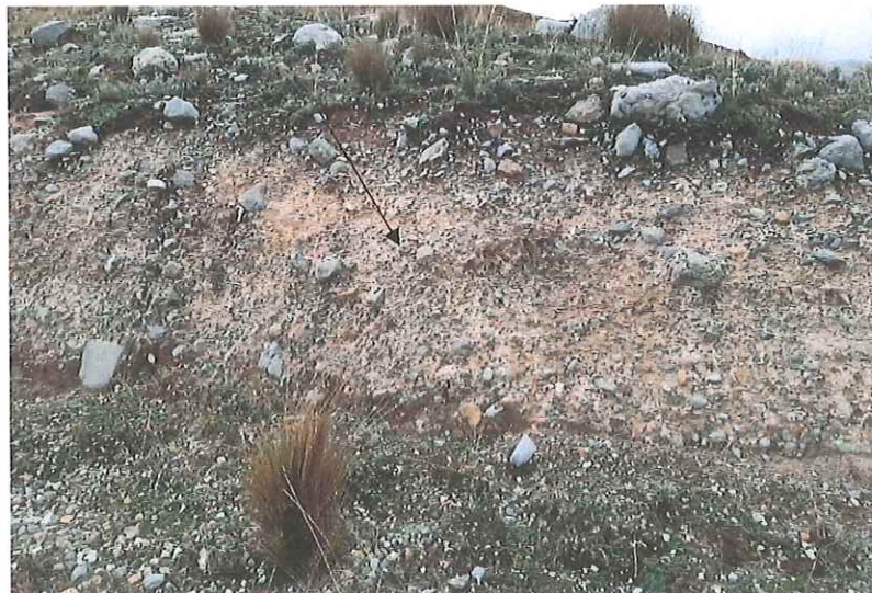
Figura 3-6 Depósitos coluviales en esta zona se aprecia ya conformación del material con una potencia mayor de 3 metros en el corte de la carretera existente
