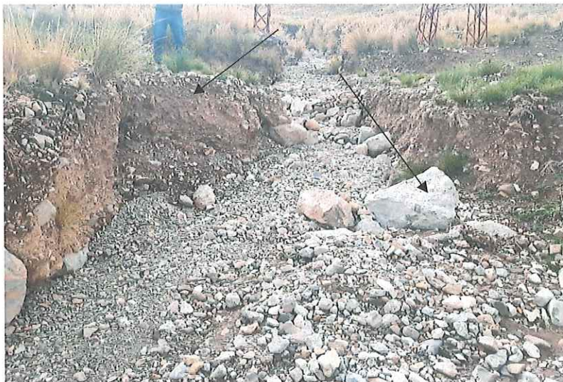
Figura 3-2 Depósitos de origen glaciares, con presencia de gravas sub angulosas a angulosas y bolonería con una matriz areno arcillosa
